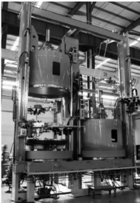
图 5 V型硫化机左开右合图示
