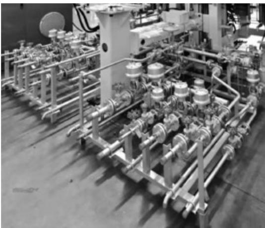
图 6 V型液压硫化机传统热工阀组
