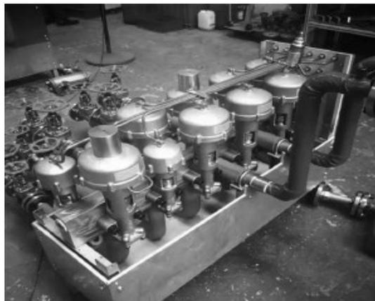
图 7 V型液压硫化机高集成热工阀组
