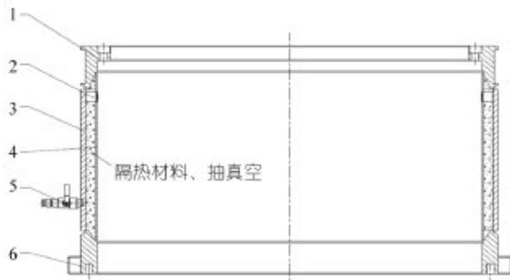
1—上硫化室体;2—隔套管;3—硫化室外壁;4—硫化室内壁;5—真空阀;6—硫化室齿圈组成
