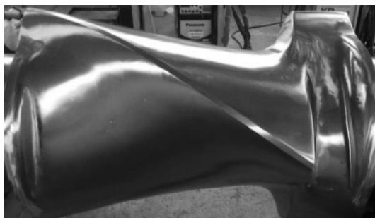
图 6 堆焊无裂纹合金的转子实物
