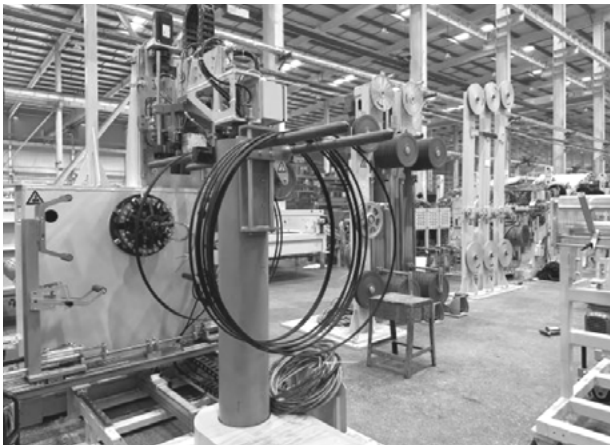
图6 单机3-一拖N 钢丝圈缠绕生产线
