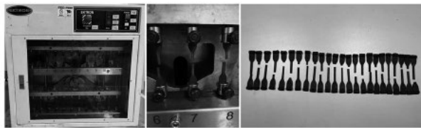
图 1 拉伸疲劳试验
