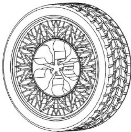
图6 激光3D打印仿丝瓜络内壁微结构的轮胎空间支撑体
