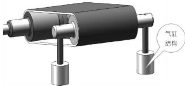
图 4 采用气缸作为驱动与摆动点效果图
