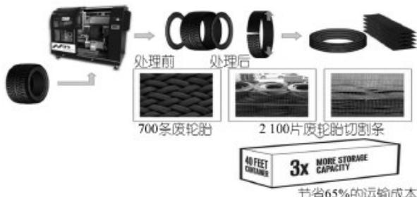
图1 废轮胎自动化的快速切割与存放示意图
