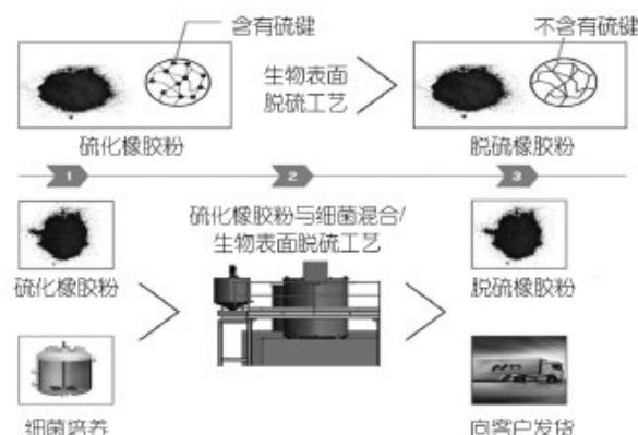
图3 硫化橡胶粉生物表面脱硫示意图
