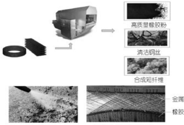
图2 切割后的废轮胎水射流绿色分离示意图
