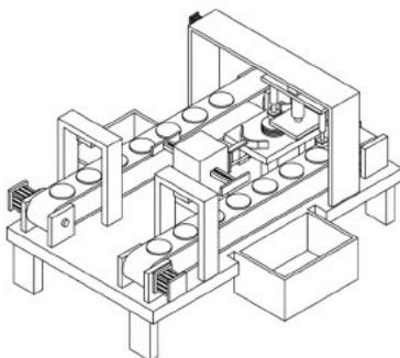
本实用新型提供一种橡胶膜片用自动检测与叠膜装置。橡胶膜片用自动检测与叠膜装置包括：工作台，工作台上设置有两个输送带，工作台上设置有叠膜机构、
