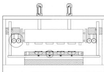
本实用新型涉及一种用于汽车的橡胶制品脱模装置，包括底座、两个支撑架、第二固定板、上模、下模、两个传动组件和四个脱模组件，两个支撑架对称固定连接在底座顶部，第二固定板固定连接在支撑架的顶部，下模固定连接在底座顶部，第二固定板顶部对称固定连接有两个气缸，两个气缸的输出轴贯穿第二固定板底部固定连接上模，两个传动组件对称设置在上模外侧，四个脱模组件等距设置在下模的内部。本实用新型的有益效果在于，利用模具的开模力带动脱模装置运行，实现自动橡胶制品的自动脱模，不需要额外的动力设备实现脱模，不仅降低了设备成本，同时减少了人工脱模的时间，从而达到提高生产效率的效果（申请专利号：CN202322556034.6）。
