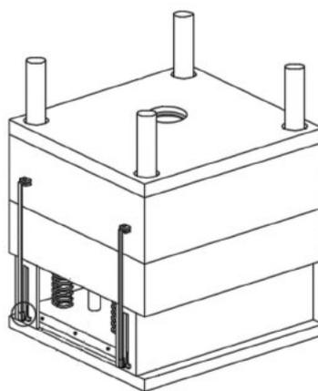
本实用新型涉及橡胶鞋底注塑领域，具体涉及一种便于脱模的橡胶鞋底注塑装置，其技术方案是：包括上模具和下模具，下模具的底部安装有底座，上模具和下模具的两侧对称设置有连接板，底座
