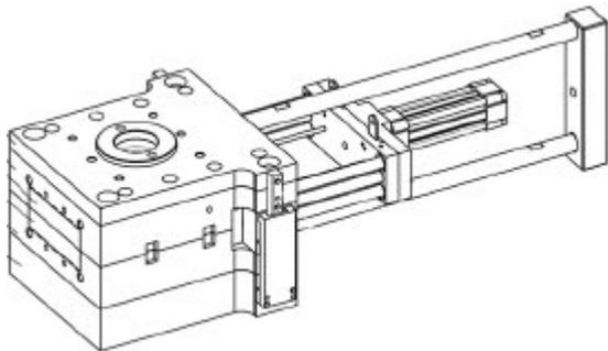
本申请公开了一种橡胶垫圈成型用注塑模具，涉及注塑成型工艺领域，其包括上模座板、上模板、下模座板和下模板，上模板与上模座板固定连接，下模板与下模座板固定连接，上模板和下模板贴合但不连接，上模板靠近下模板的一侧设置有第一凹模，下模板靠近上模板的一侧设置有第二凹模，第一凹模和第
