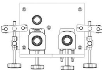
本实用新型涉及橡胶加工技术领域，尤其涉及一种橡胶辊压送料装置，包括辊压送料机构，辊压送料机构包括固定架，固定架包括固定底座及固定支架，固定支架设置在固定底座的两侧，固定支架之间水平设置有压辊组件，压辊组件包括上压辊及下压辊，上压辊和下压辊之间形成运输通道，固定支架安装设置有加强筋，压辊配合加强筋设置有输料滚筒，该橡胶辊压送料装置将驱动装置与压辊组件连接设置，实现驱动效果，上压辊和下压辊之间形成的运输通道，可供物料进出，下压辊一侧平等高度设置送料压辊，便于物料的运出，实现自动送料，提高生产效率（申请专利号：CN202322755753.0）。
