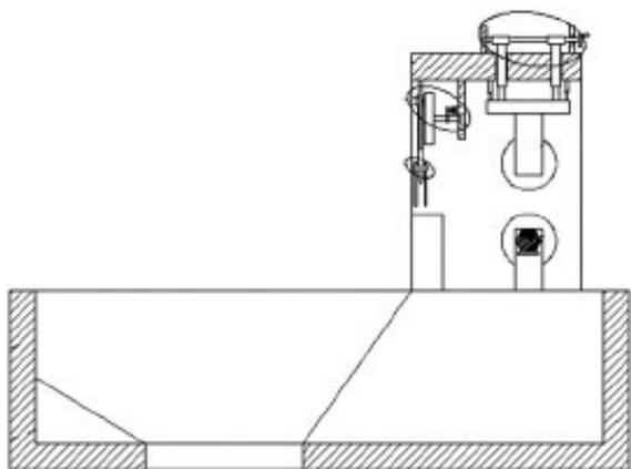
本实用新型涉及一种橡胶注射硫化设备的喂料机构，包括壳体，壳体的内腔底部左侧处固定连接有三角块，壳体的底部靠近左侧处开设有矩形开口，壳体的内腔底部右侧处固定连接梯形块，梯形块的顶部靠近左侧处固定连接有垫块，梯形块的顶部靠近后侧处固定连接L形板，通过固定板、剪切电机、传动皮带、传动杆、圆盘、驱动杆、固定框、限位块、限位杆、连接杆、移动块和切割刀这些部件的相互配合，能够无需人工手动剪切，提高橡胶条或者橡胶片剪切效率，通过矩形块、蜗杆、蜗轮、波纹管 and 螺杆这些部件的相互配合，能够适用于不同厚度橡胶条或者橡胶片向前传送，提高装置的使用范围（申请专利号：CN202322508482.9）。
