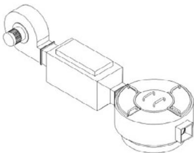
支臂，支臂末端延伸至电机舱与烘干箱之间，支臂末端设置翻滚支架，翻滚支架中心设置第一滚筒和第二滚筒，
