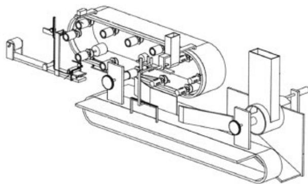
组件、上料组件、分切组件，包裹机构包括支撑组件、切断组件以及驱辊组件；本发明中一体化的设备能够自动完成橡胶卷的整个打包工作，结构联动性较好，能够批量化卷收橡胶并打包起来，橡胶卷的打包效果较佳，防止橡胶卷在存放或运输过程发生松散，提高了橡胶的打包效率，增加了企业的生产效益，解决了现有方案不能对橡胶卷的外壁和端部进行紧密打包，造成橡胶卷打包的牢固性较差，导致橡胶卷在运输过程中发生松散的技术问题（申请专利号：CN202210649603.9）。
