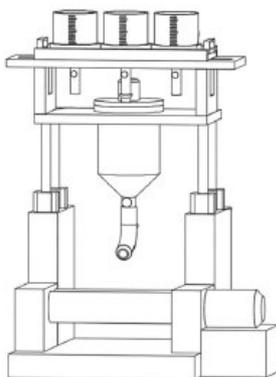
本实用新型涉及橡胶密封件生产设备技术领域，且公开了一种生产橡胶密封件的配料混炼装置，包括基座机构，气缸支架机构，气缸支架机构包括气缸支架，基座上固定连接气缸支架，支架板上固定连接支撑架，
