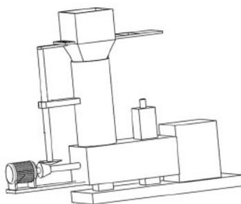
本实用新型公开了一种橡胶胶条挤出装置，包括挤出装置本体，挤出装置本体上安装有进料管和伺服电机，伺服电机上安装有驱动轴，驱动轴转动安装在挤出装置本体上；挤出装置本体上安装有下料结构，本实用新型，通过活动板、下料口和出料口等结构的设置，在使用挤出装置本体对橡胶胶条挤出时，为了避免传统的胶条挤出装置一次添加过量的橡胶原料，导致原料在经过进料管时不能被充分加热融化，从而利用第一伞型齿轮带动调节杆转动，调节杆带动活动板在储料箱上做往复运动，从而使储料箱底侧的下料口和活动板上的出料口间歇重合，从而能使储料箱内的原料能等量间歇的下落进入进料管内进行充分完全的加热融化（申请专利号：CN202322972838.4）。
