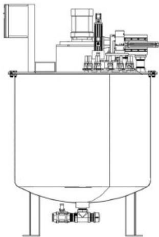
本实用新型公开了一种助剂自动加注型橡胶密炼机，包括：密炼罐体、助剂转换库、定量加注组件和若干用于装填不同液体助剂的活塞注射筒，密炼罐体的顶面设有顶盖，助剂转换库和定量加注组件固定安装于顶盖顶部；助剂转换库包括固定于顶盖顶面的固定导座和转动
