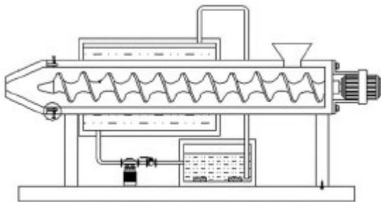
本实用新型涉及一种注塑橡胶件用挤出模具，包括底座底座的顶端固定有四个支撑腿，支撑腿的顶端固定有模具本体，底座的顶端设有冷却机构，模具本体的左端抵接有出料管，模具本体的左端设有安装机构，模具本体的右端固定有电机，电机的输出轴固定有蛟龙，模具本体的顶端固定有进料口。该注塑橡胶件用挤出模具，通过在底座的顶端设有冷却机构，使得模具本体能够通过冷却箱中的冷却液进行降温，从而加快橡胶件冷却成型，通过在模具本体的左端设有安装机构，使得出料管便于进行更换，同时能够根据需要使用不同类型的出料管，整体的挤出效果较好，能够满足挤出模具的使用要求（申请专利号：CN202322500253.2）。
