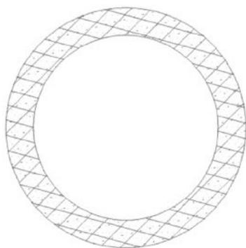
本发明公开了一种耐高温金属橡胶复合结构密封垫及其制备方法，属于密封材料技术领域。金属橡胶密封垫由以下原料制成：基底金属橡胶、填充物聚四氟乙烯、石墨、云母。填充物按重量百分比由石墨2~5%、云母5~20%，余量为聚四氟乙烯组成，其制备方法包括如下步骤：填充物预处理→研磨→混合→加入金属橡胶毛坯→加压成胚料→烧结并冷却→加工成成品。本发明制备的金属橡胶密封垫以金属橡胶为骨架，聚四氟乙烯、石墨、云母的均匀混合物作填充，通过填充改性克服了传统聚四氟乙烯密封垫的冷流效应、蠕变性差、回弹性差的不足，同时提高了密封性能，填补了高温高压下清洁密封的空白（申请专利号：CN202210461899.1）。
